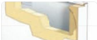
Embouts de panneaux en bois et isolation au polyuréthane servant de bris thermique pour éliminer le transfert de froid
